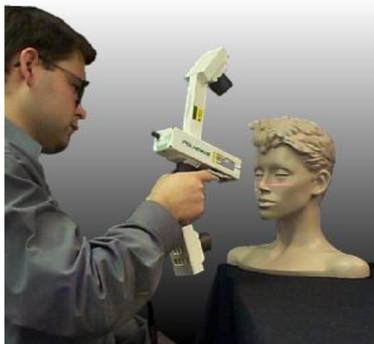
Figura 4: Scanner 3D manual, baseado em Visão Estéreo e projeção laser.
